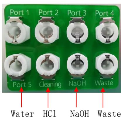
**纯水说明：**在纯化及再生过程结束后，仪器将使用纯水自动进行管路清洗，对应到仪器的管路端口号为 Prot5。
