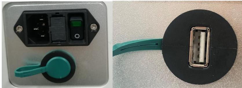
**注：**电源开关与 USB 端口位于仪器左侧板上, 并且 USB 端口用于更新系统软件和导出 LOG 文件。
